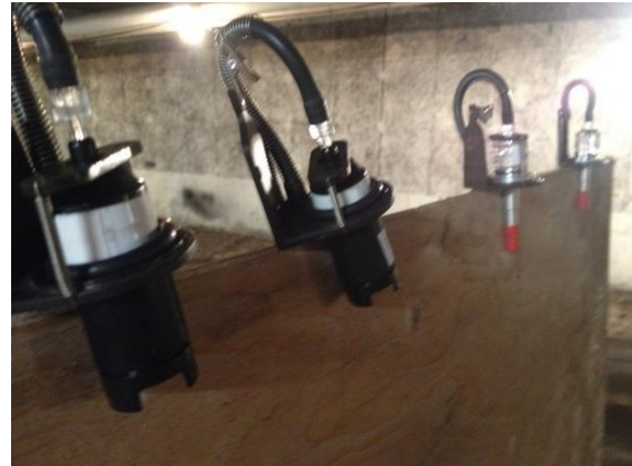
Filter för partikelanalys närmast och filter för respirabelt damm längs bort. Filtren placerades cirka 1,5 m över golvet.
